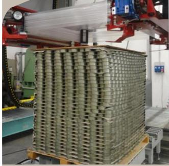
Si requiere optimizar sus procesos de empaque y distribución de sus productos, debe conocer todos los sistemas de automatización de final de línea, con sistema de paletizado y enfundado tipo campana estirable o termo contraíble, con amplios beneficios para el manejo, almacenamiento y transporte de su producto terminado.
